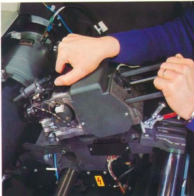
Die mit Film beschickte Tageslichtkassette wird eingesetzt.
