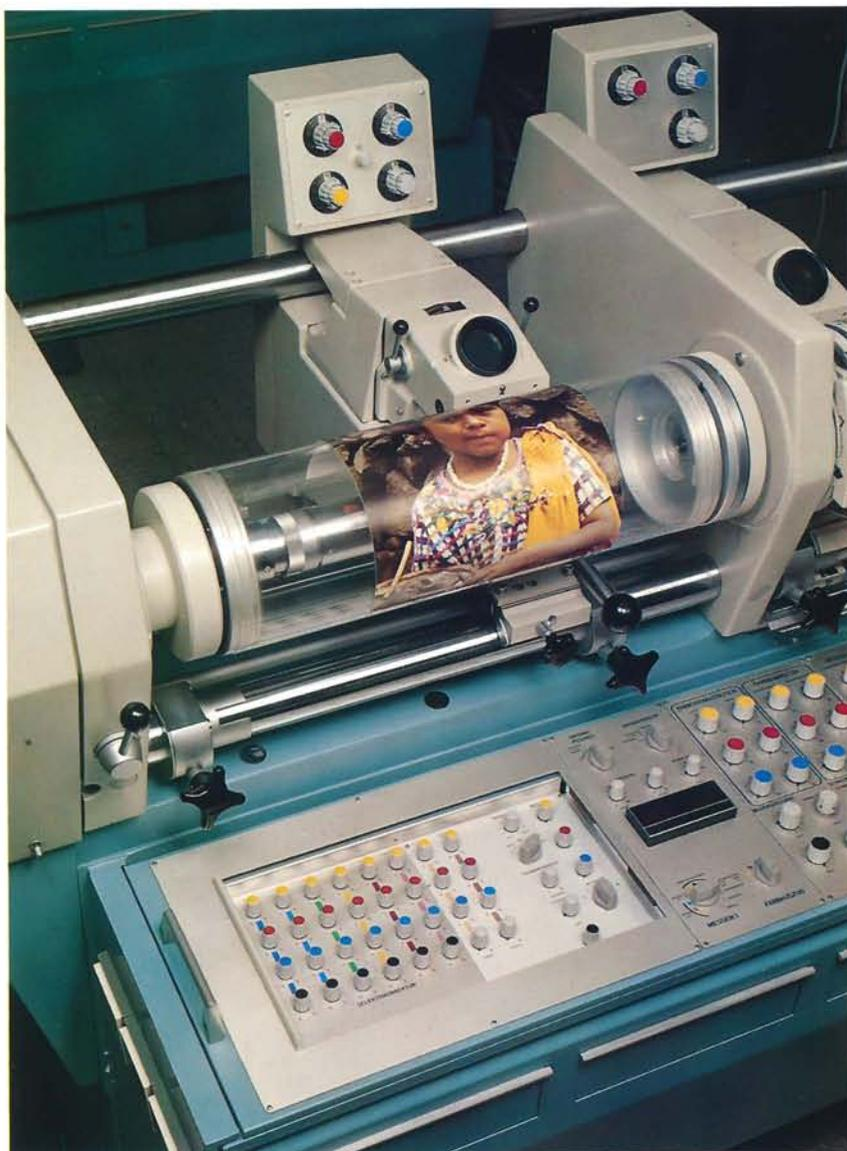
Dem Wunsch nach kurzen Rüstzeiten und damit guter Ausnutzung der hohen Arbeitsgeschwindigkeit des Chromagraph DC 300 kommen die herausnehmbaren Abtastwalzen und die automatische Aufspannung der Auszugsfilme und Kontaktraster auf die Schreibwalze bei vollem Tageslicht sowie die Vorwahl der für den jeweiligen Druckprozess geeigneten Gradation entgegen.
