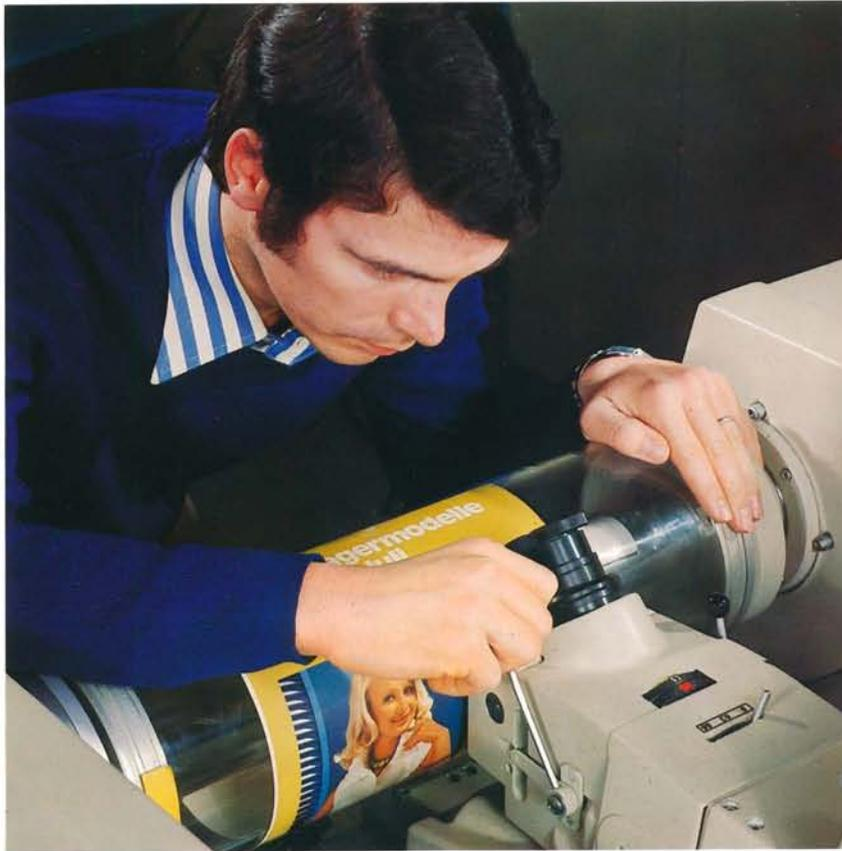
Die Schärfe des Abtastobjektivs wird am Einblick-Tubus kontrolliert.
